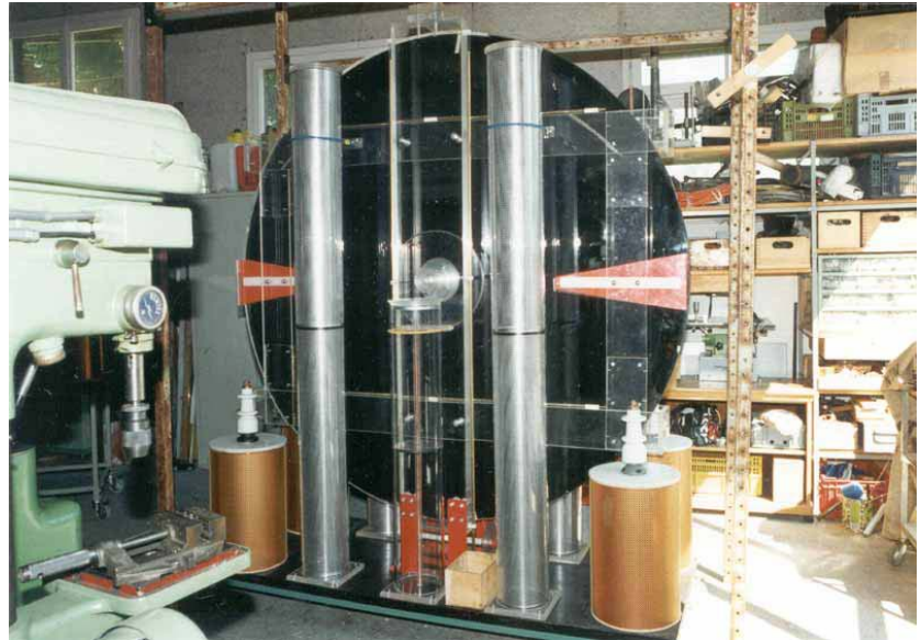
Testatika mit 2m-Scheiben, 30kW Leistung
